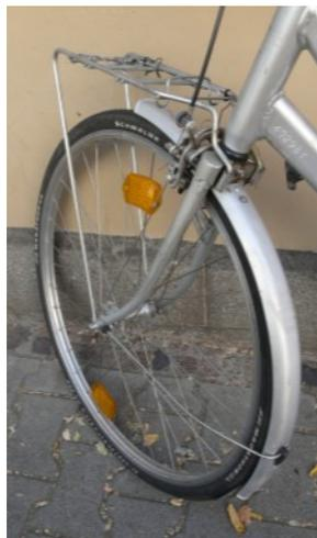
Placé autour des roues du vélo, le garde-boue protège le conducteur de l'eau et de la boue.
