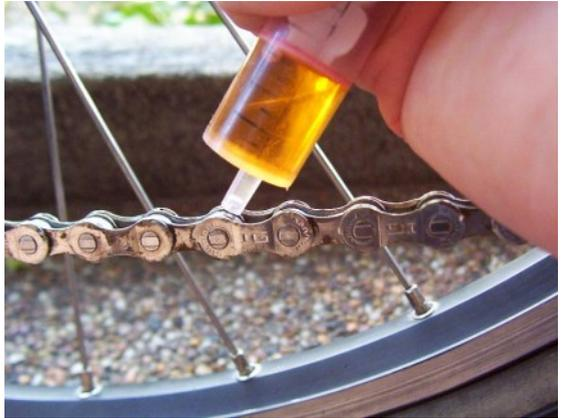
Il faut mettre de l'huile ou de la graisse sur la chaîne.
