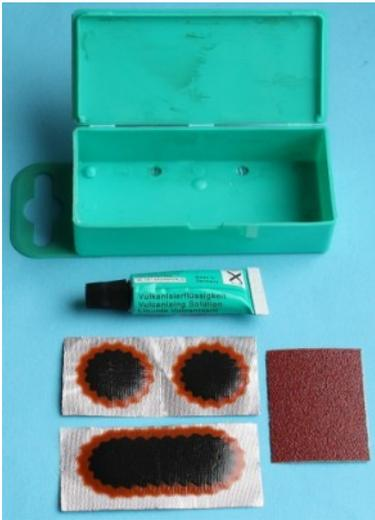
Pour faire tenir une rustine sur la chambre à air, on utilise un liquide, la dissolution : elle va dissoudre légèrement le caoutchouc et permettre aux deux parties d'adhérer. C'est plus solide que le collage.
