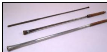
Les cannes en fer creuses pour cueillir le verre, le travailler et le souffler.
