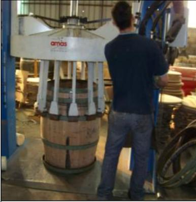
Les cercles de métal provisoires sont enlevés et remplacés par des cercles définitifs. Il en faut 6 pour les barriques de 225 et 228 litres, 8 pour les barriques de 265 à 600 litres. Ces cercles assurent aussi l'étanchéité de la barrique.
