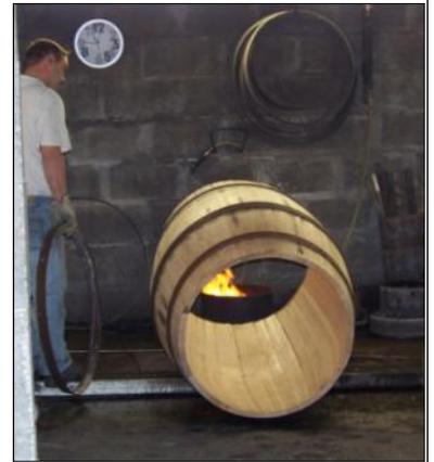
*Cette barrique est en fin de chauffe : elle est cintrée et munie des cercles provisoires d'assemblage.*
