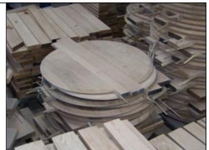
L'assemblage n'utilise que du bois (ni colle, ni métal). Pour le fonçage : les fonds sont taillés. Puis, ils sont placés sur les barriques dans des encoches prévues à cet effet. Lorsque les fonds sont en place, le tonnelier vérifie l'étanchéité : il remplit chaque fut de 10 litres d'eau chaude sous pression.
