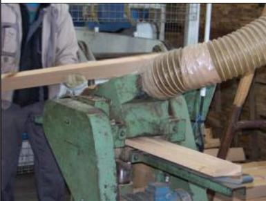
Chaque merrain est travaillé pour devenir une douelle. L'artisan le scie à la longueur du tonneau. Il rabote le dessus et les côtés. Il donne au merrain la forme légèrement arrondie du tonneau.
