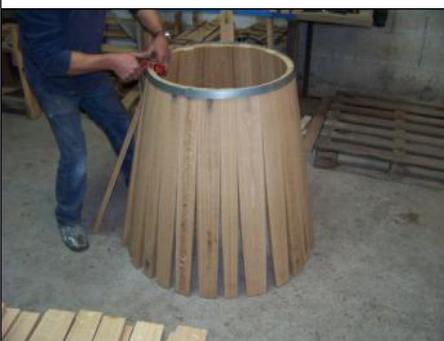
À l'aide d'un marteau spécial, le tonnelier place les cercles provisoires de métal sur le tonneau. La barrique ainsi assemblée est prête pour la chauffe.
