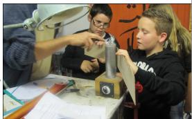
Quand il est chaud, on humidifie le bois et on le presse contre le fer. Petit à petit, le bois se déforme et se courbe. L'ajustement précis se fait ensuite dans un moule.
