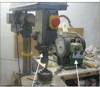
La perceuse à colonne radiale fait des trous en biais.
