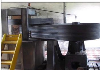
Par un système de courroies, cela fait tourner la génératrice (dynamo) qui fabrique de l'électricité.
