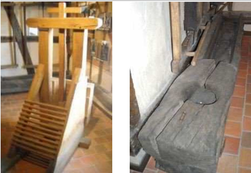
À gauche, la maquette d'une bonde d'étang. À droite, une vieille bonde : on voit le trou où vient se loger le bouchon.
